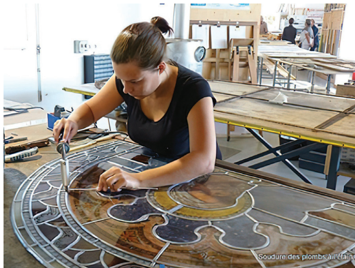
Soudure des plombs à l'étain (photographies 2011, collection Aimé Jeanjean)
